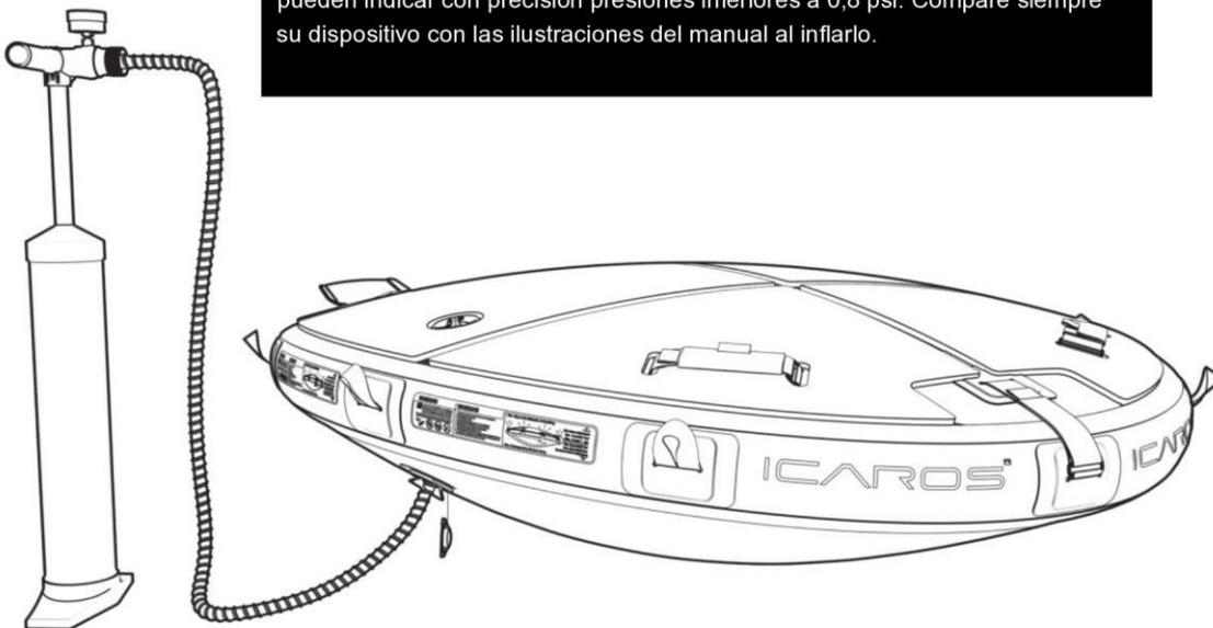
Ahora se puede inflar la cámara inferior. La presión de aire bombeada a la cámara inferior debe ser mín. 0,2 psi / 0,01 bar o máx. 0,8 psi / 0,05 bares. La presión ideal en el fondo es de 0,5 psi / 0,03 bar. Asegúrese de que el bloqueo de la tapa de la válvula esté cerrado después del inflado.
