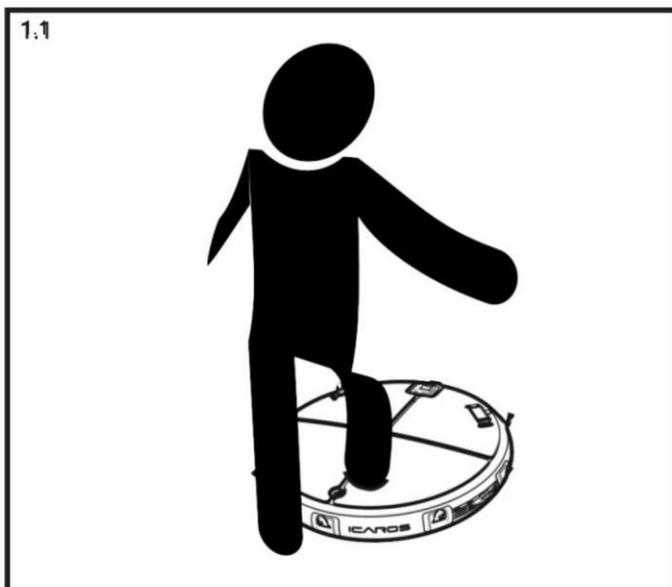
Para acceder a ICAROS Cloud 360, debe pararse detrás del dispositivo. Primero coloque un pie con el talón al nivel de la válvula y transfiera lentamente todo su peso sobre esta pierna.
