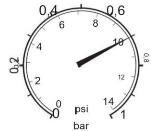
Para inflar ICAROS Cloud de forma segura, primero debes inflar la cámara superior. La Nube ICAROS debe desplegarse en el suelo. La presión de aire bombeada a la cámara superior debe ser mín. 10 psi / 0,7 bar o máx. 14 psi/1 bar. La presión ideal en la parte superior es de 12 psi / 0,85 bar. Asegúrese de que el bloqueo de la tapa de la válvula esté cerrado después del inflado.
